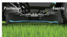
La cuchilla está diseñada de manera que se inclina hacia la parte delantera de la máquina cuando está acoplada, lo que evita el doble corte para reducir el consumo de corriente.
